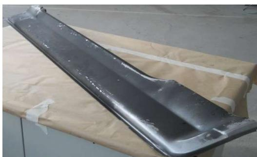
**Деталь А<sub>1</sub>, Деталь А<sub>2</sub> – наружная панель порога.**
