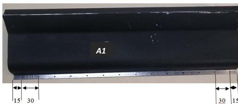
Схема №1 Расположение контактной точечной сварки.
