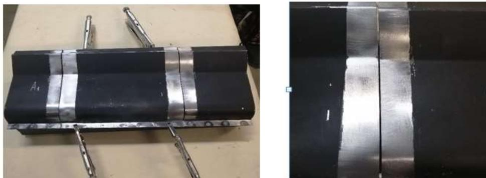
**!** *Стыковой зазор должен быть не менее толщины металла и не должен превышать толщины 2-х металлов.*
